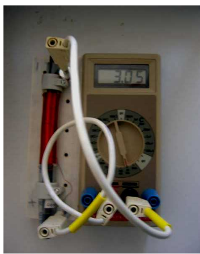
bobine avec bâton de ferrite: L_{\max} = 3,05 \text{ mH}
