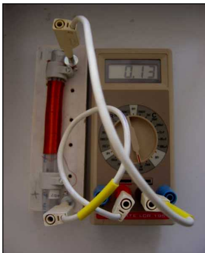
bobine sans bâton de ferrite: L_{\min} = 0,13 \text{ mH}
