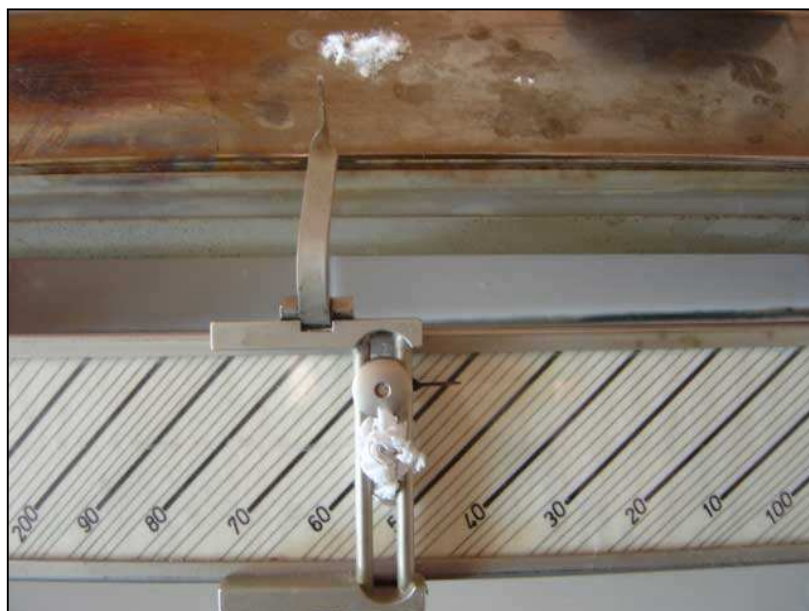
Etalonnage du banc Kofler avec de l'acide salicylique: T_{\text{fus}} = 159 \text{ }^\circ\text{C}
