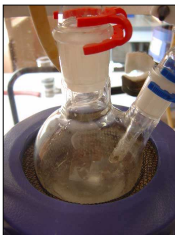
ébullition douce du mélange d'alcool benzylique et de solution de soude
