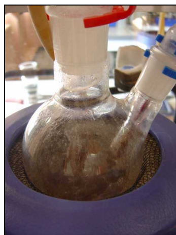
Introduction du permanganate de potassium par l'ampoule de coulée au goutte à goutte
