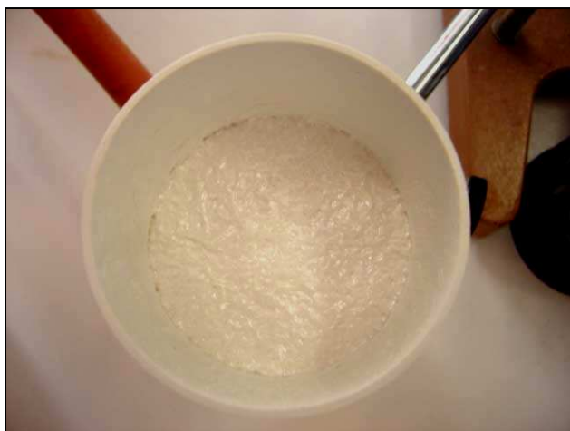
Récupération de l'acide benzoïque après filtration sur büchner.
