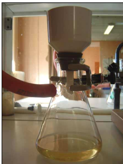
Filtration du mélange réactionnel sur filtre büchner
