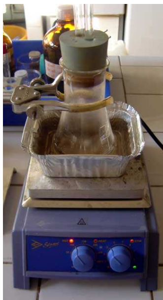
Agitation et chauffage sur agitateur magnétique chauffant
