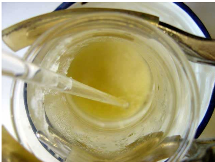
On peut ensuite aider la cristallisation en "raclant" le fond de l'erenmeyer avec un agitateur en verre (création de germes).
