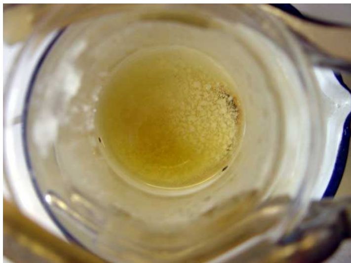
Cristallisation du paracétamol dans le bain marie d'eau froide
