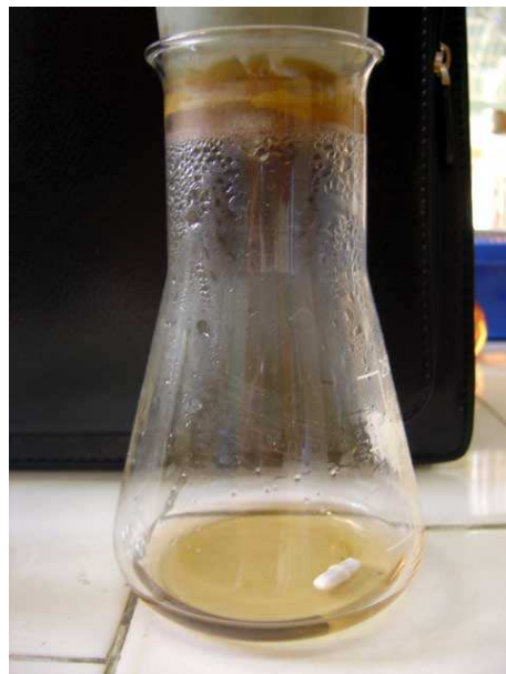
Dissolution totale du para-aminophénol dans la solution d'acide éthanoïque.
