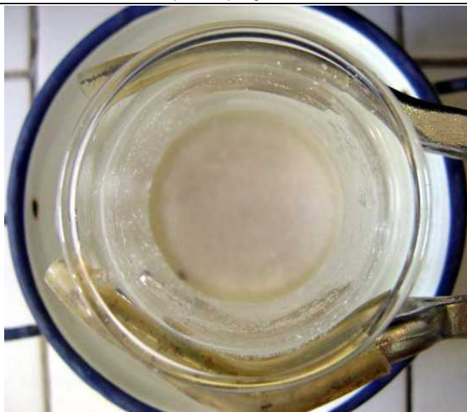
Recrystallisation du paracétamol dans un bain marie d'eau glacée
